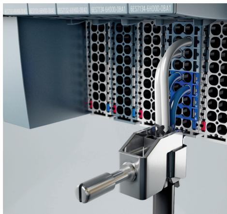
SIMATIC ET 200SP 採用一致的屏蔽概念，確保最高可能的電磁相容性，並提升通訊可靠性。
